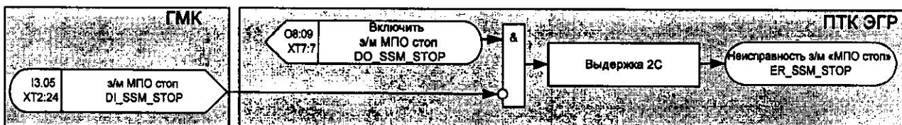
Рис. 3.18. Неисправность э/м «МПО стоп»
